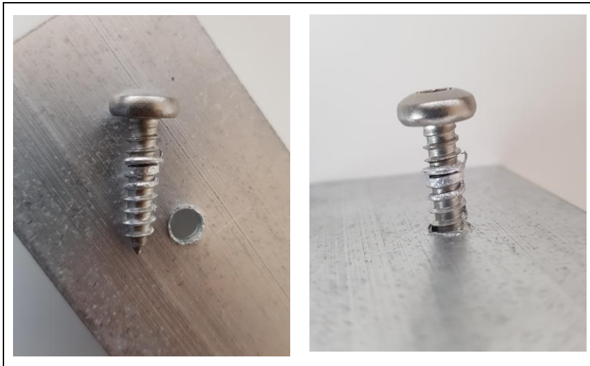
Figuur 04.5 Afschuiven van aluminium draad
