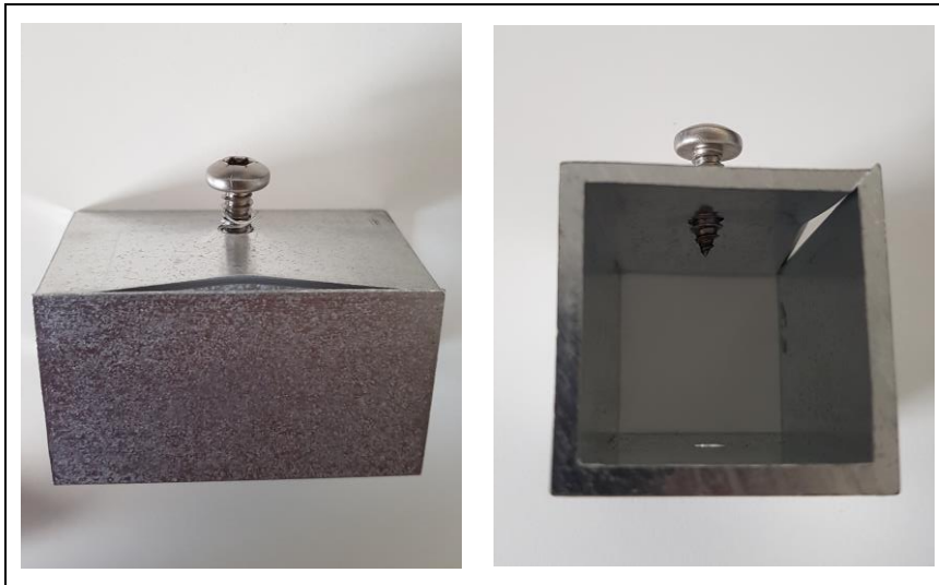
Figuur 04.7 Scheuren van wand koker (6.3-S5)
