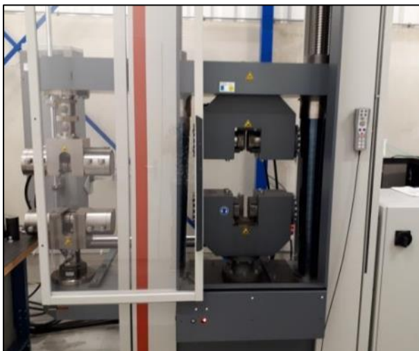
Figuur 04.3 Trekbank Zwick / Roell Z600
