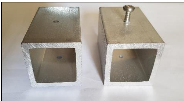
Figuur 04.2 Voorbeeld van proefstuk met en zonder schroef
