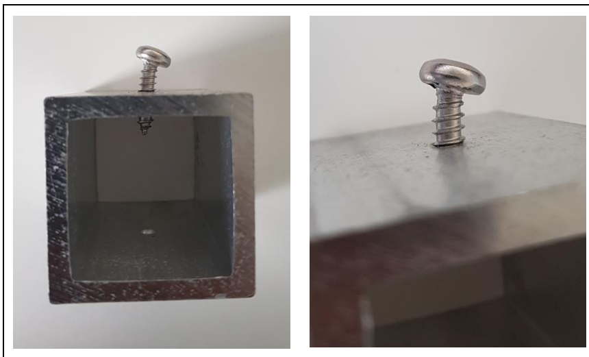
Figuur 04.6 Verdraaien schroefkop (test 4,8-S7-01)
